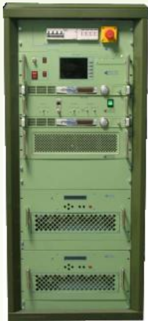
FM передавач TXFM-5000-R-N P вих =10кВт
