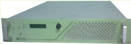
Компактний FM передавач TXFM-1000-N Р вих =1000Вт
