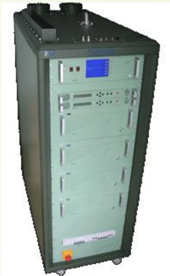
DVB-T/T2 передавач TXTU-1200-R-2-N Решт=2000Вт
