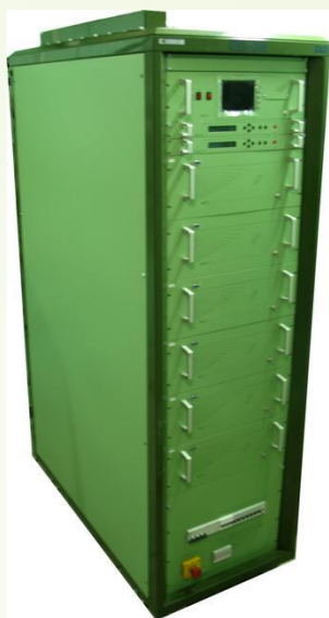
DVB-T/T2 передавач TXTU-2500-R-2-N P вих =2500Вт
